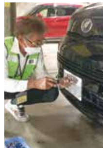
↑ ナンバープレート盗難防止ネジの取り付け
