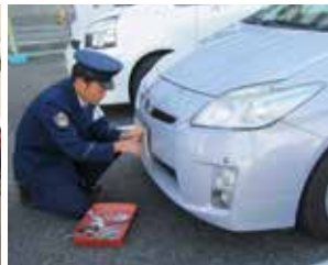
ナンバープレート盗難防止ネジ取り付け
