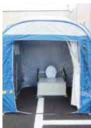
車椅子対応 マンホールトイレ
