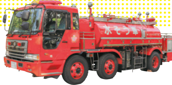
小型動力ポンプ付水槽車 せうがたどうりょく つき すいそうしや
